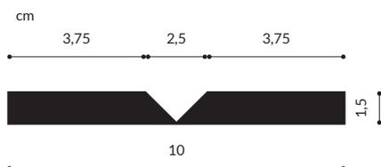
Protezioni d'angolo realizzate in E.V.A. ideali per risolvere le situazioni in cui la bordatura dell'angolo è esposta agli urti. Grazie all'elevata resistenza ed elasticità dell'E.V.A. le protezioni hanno un altissima capacità di assorbimento degli urti e permettono di ridurre i problemi di sicurezza negli spazi interni ed esterni. La protezione è atossica, repellente a tutte le sostanze, antimuffa ed antibatterica. Si applica con apposito collante a presa rapida.
